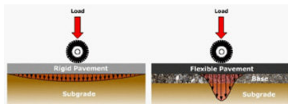
شکل (۳): نحوه توزیع تنش رویه های آسفالتی و بتنی
